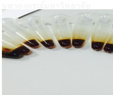
รูปที่ 4.2 ลักษณะของสารลดแรงดึงผิวชีวภาพที่สกัดได้จาก B. subtilis BBK-1 เป็นของเหลวหนืดสีเหลืองถึงน้ำตาลเข้ม
