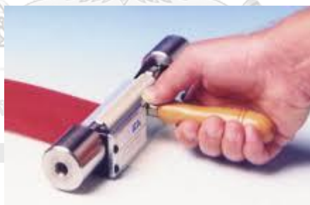
ภาพที่ 3.2 เครื่องพิมพ์จำลองรุ่น K Lok Proofers
