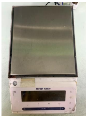
ภาพที่ 3.1 เครื่องชั่งน้ำหนักรุ่น MS3002SE ยี่ห้อ Mettler Toledo
