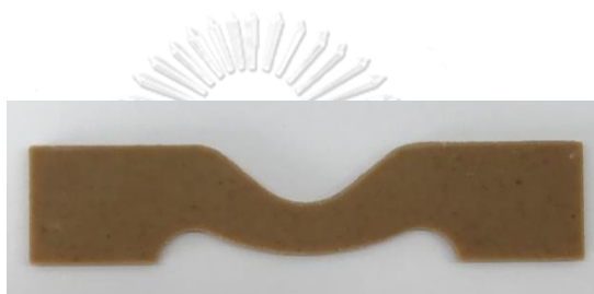
รูปที่ 3.15 ชิ้นทดสอบแบบ angle สำหรับทดสอบความทนการฉีกขาด
