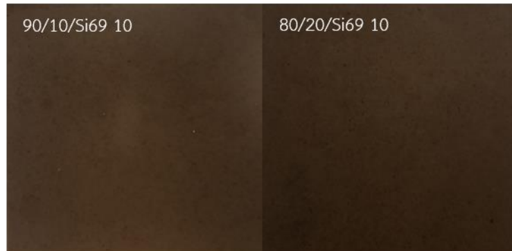
รูปที่ 4.26 แผ่นฟิล์มยางธรรมชาติผสมแป้งมันฝรั่งที่เติมสารคู่ควบไซเลน (NR/PS/Si69) จากการเตรียมด้วยกระบวนการ dry mixing
