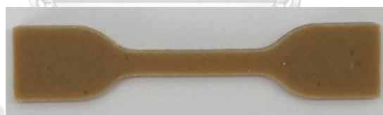
รูปที่ 3.13 ลักษณะตัวอย่างชิ้นงานรูปดัมเบลล์สำหรับทดสอบความทนแรงดึง
