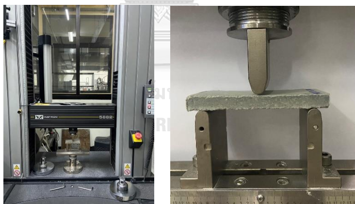
รูปที่ 3.2 เครื่องทดสอบความต้านแรงดัดแบบ 3 - Point bending
