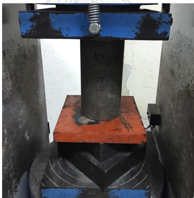
รูปที่ 68 การทดสอบกำลังรับแรงอัดของจีโอพอลิเมอร์คอนกรีต
