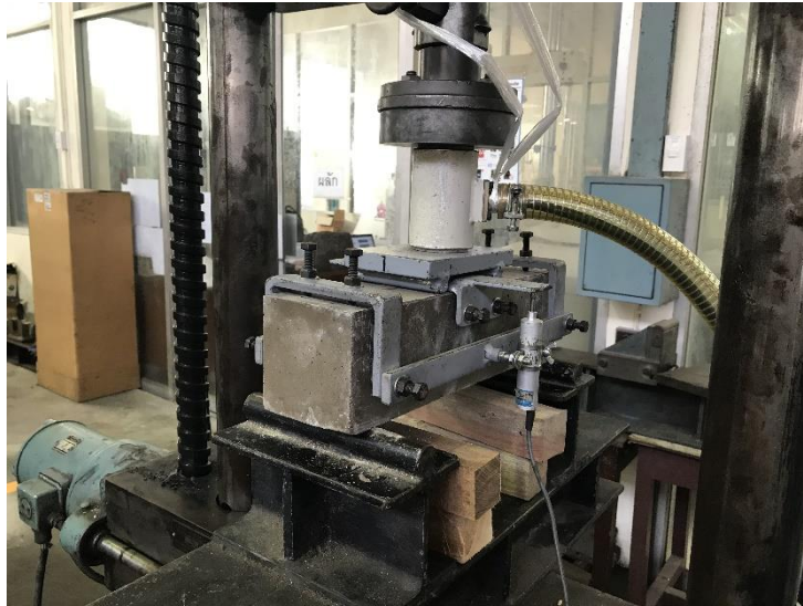
รูปที่ 35 ลักษณะการติดตั้งตัวอย่างและเครื่องมือการทดสอบตามมาตรฐาน ASTM C1609
