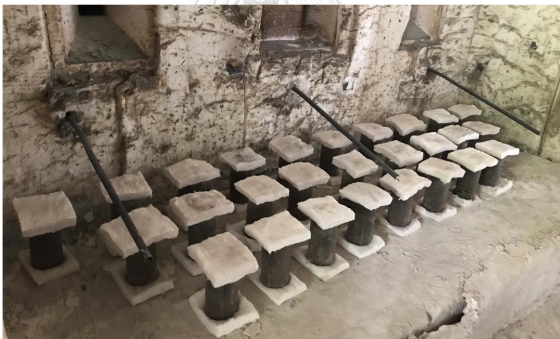
รูปที่ 70 การทดสอบความทนทานของจีโอพอลิเมอร์คอนกรีตในสภาวะเพลิงไหม้
