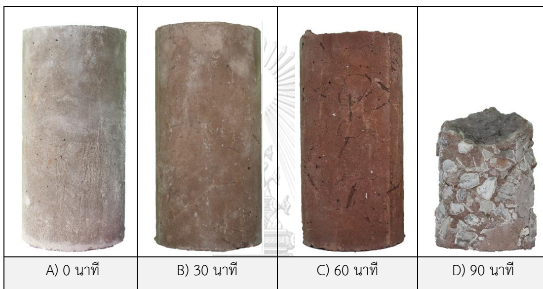
รูปที่ 56 ตัวอย่างจีโอพอลิเมอร์คอนกรีตหลังการทดสอบเผาไฟที่เวลา 0, 30, 60 และ 90 นาที
