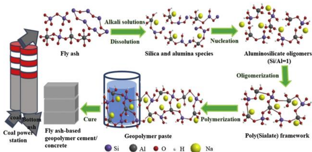
รูปที่ 3 กระบวนการผลิตจีโอพอลิเมอร์จากเถ้าลอยโรงไฟฟ้าถ่านหิน (Zhuang et al., 2016)
