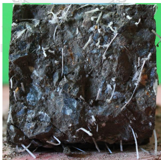
รูปที่ 52 ลักษณะการเสียรูปของเส้นใยพอลิโพรไพลีนภายใต้การรับกำลังดัด
