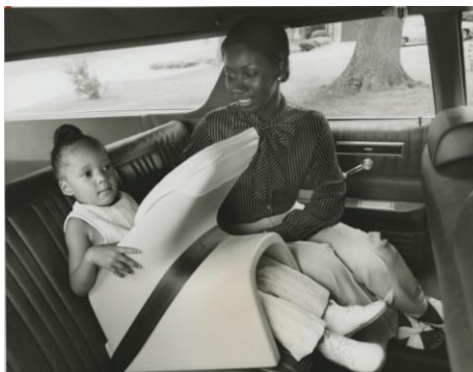
รูปที่ 3 ที่นั่งนิรภัยสำหรับเด็ก Tot-guard ออกแบบโดย บริษัท ฟอร์ด มอเตอร์ (The Henry Ford 1973)
