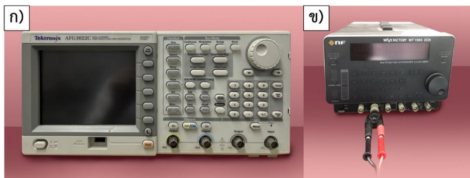
รูปที่ 3.13 เครื่องกำเนิดสัญญาณไฟฟ้า. ก) AFG3022C. ข) WF1966.
