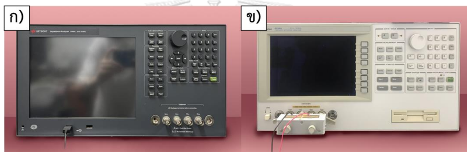
รูปที่ 3.12 เครื่องวิเคราะห์อิมพีแดนซ์. ก) E4990A. ข) 4294A.
