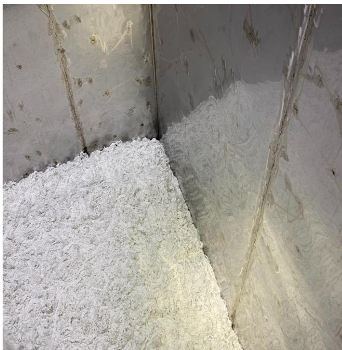
รูปที่ 4.17 การจัดเรียงตัวของเส้นใยไม่ดี
