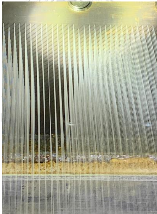
รูปที่ 4.6 เส้นใยไหลผ่านรูฉีดเส้นใย
