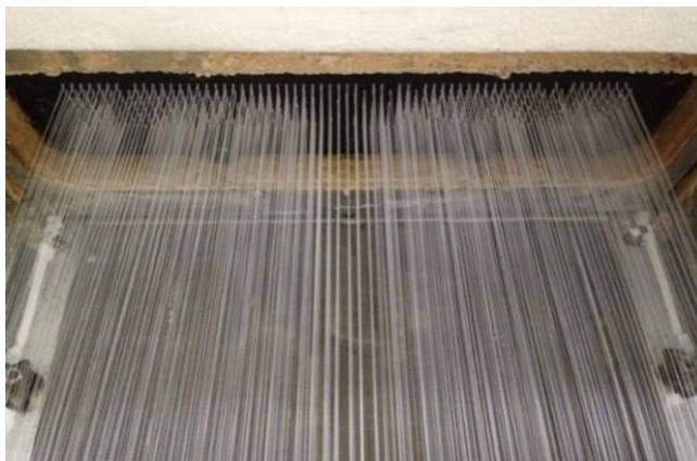
รูปที่ 3.2 ฉีดพอลิเมอร์ผ่านรูฉีดพอลิเมอร์ผ่านรูหัวฉีดเส้นใย
