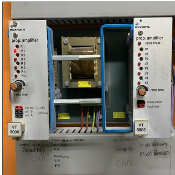
รูปที่ 5.7 อุปกรณ์สำหรับปรับเวลาการเคลื่อนที่ของลูกกลิ้ง และถังใส่เส้นใย
