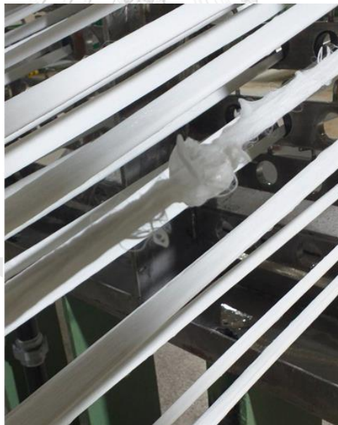
รูปที่ 4.15 ปมธรรมชาติระหว่างกระบวนการผลิต
