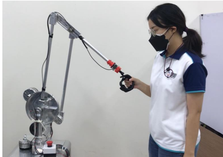
รูปที่ 28 การทดสอบส่วนขดเขย่น้ำหนักของแขนหุ่นยนต์ในระบบควบคุม
