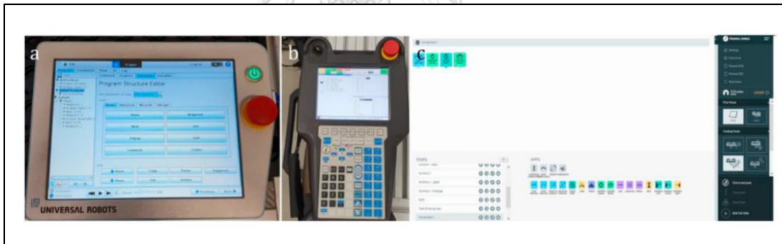
รูปที่ 1.3 ส่วนเชื่อมต่อผู้ใช้ (ก) Universal Robot UR5; (ข) Fanuc CR-7iA; (ค) Franka Emika PANDA.
