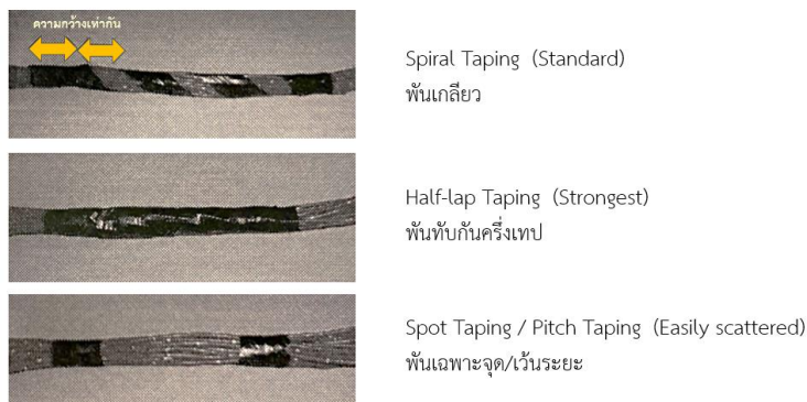
รูปที่ 3 ลักษณะการพันของเทปพันสายไฟทั้ง 3 รูปแบบ (แหล่งที่มา : ภาพจากบริษัทกรณีศึกษาที่ใช้สำหรับการนำเสนอเท่านั้น)
