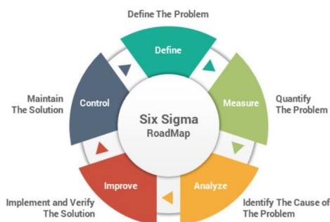
รูปที่13 แผนภาพวงจรการทำงานของกระบวนการของ DMAIC
