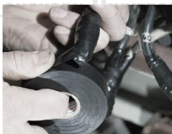
รูปที่11 การใช้เทปพันสายไฟของพนักงานในโรงงานประกอบสายไฟในรถยนต์
