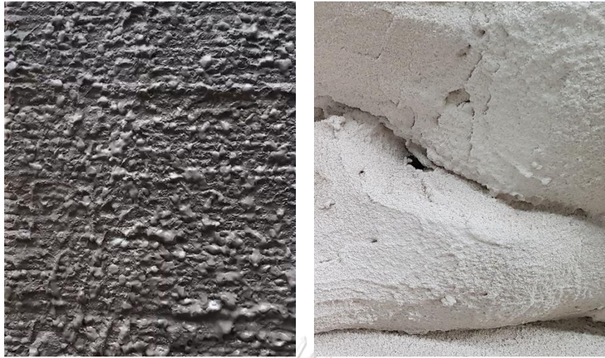
ภาพที่ 46 พื้นผิวก่อน และภายหลังการพ่นเคลือบให้ขรุขระด้วยไดแคลเซียมฟอสเฟส (Di-calcium Phosphate)
