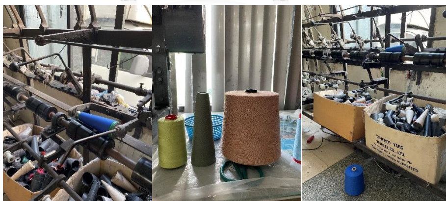
ภาพที่ 87 ขั้นตอนการรวมเส้นใยเศษเหลือจากม้วนเล็ก ๆ หลาย ๆ ม้วน มาเป็นม้วนใหญ่ม้วนเดียวกัน
