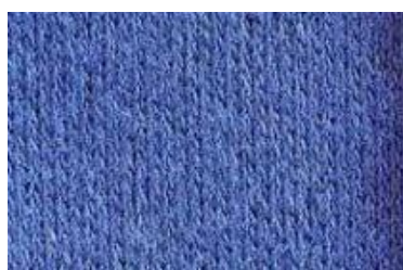
ภาพที่ 10 ตัวอย่าง ผ้าถักแบบอินเตอร์ล๊อค
