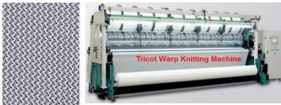
ภาพที่ 12 เครื่องถักแบบทริคอต (Tricot Warp Knitting Machine)
