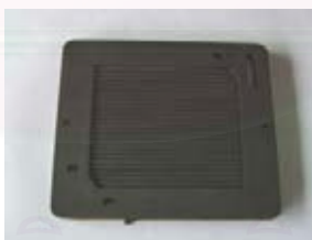
รูปที่ 3.8 ลักษณะช่องทางไหลใน bipolar plate ของหน่วยชั้นเซลล์เชื้อเพลิง แบบตรง (Straight channel flow pattern)
