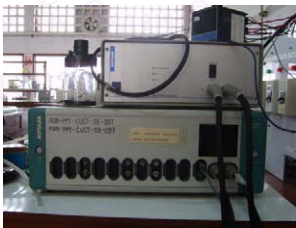
รูปที่ 3.2 เครื่อง Potentiostat/ Galvanostat รุ่น PG STATO 30 ของบริษัท Autolab
