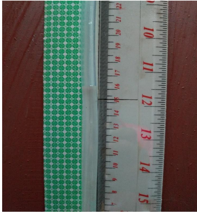
รูปที่ 3-5 แสดงการหาอัตราการไหลจากมานอมิเตอร์จากสันฝาย (H)
