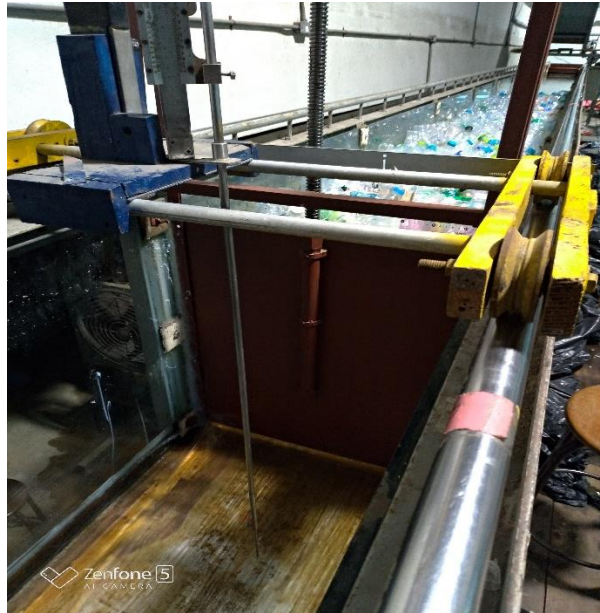
รูปที่ 3-7 เครื่องมือวัดการไหลแบบอิสระ (point gauge)
