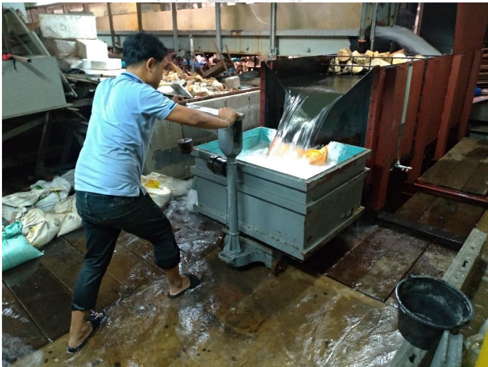
รูปที่ 3-4 รูปแสดงการสอบเทียบหาค่าอัตราการไหล (Q)
