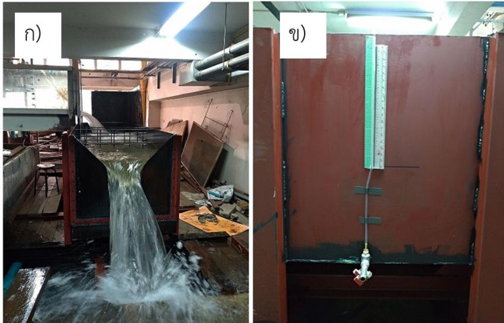
รูปที่ 3-3 ก) รูปแสดงฝายสันคัม ( V-notch weir) ข) มานอมิเตอร์ (manometer) วัดอัตราการไหล
