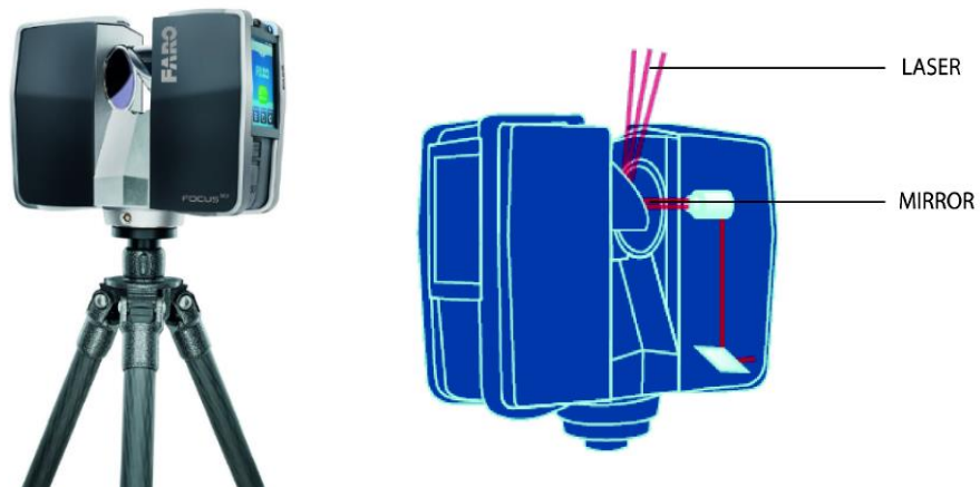
ภาพที่ 2.12 เครื่องสแกนเลเซอร์ (Laser Scanner) (ที่มา: FARO® Laser Scanner Focus3D Manual)
