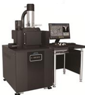
รูปที่ 4 กล้องจุลทรรศน์อิเล็กตรอนแบบส่องกราด และสเปกตรัมเอ็กซ์เรย์แบบกระจายพลังงาน [53]
