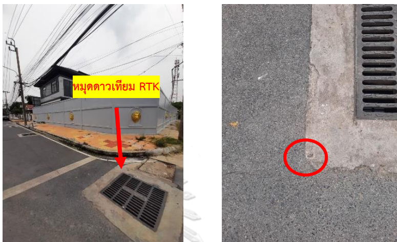
รูปที่ 4 ตัวอย่างสภาพแวดล้อมบริเวณหมุดดาวเทียม RTK และตัวอย่างหมุดดาวเทียม RTK
