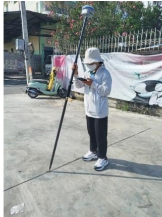
รูปที่ 33 ตัวอย่างการรังวัดขณะเอียงบนหมุดดาวเทียม RTK กรมที่ดิน
