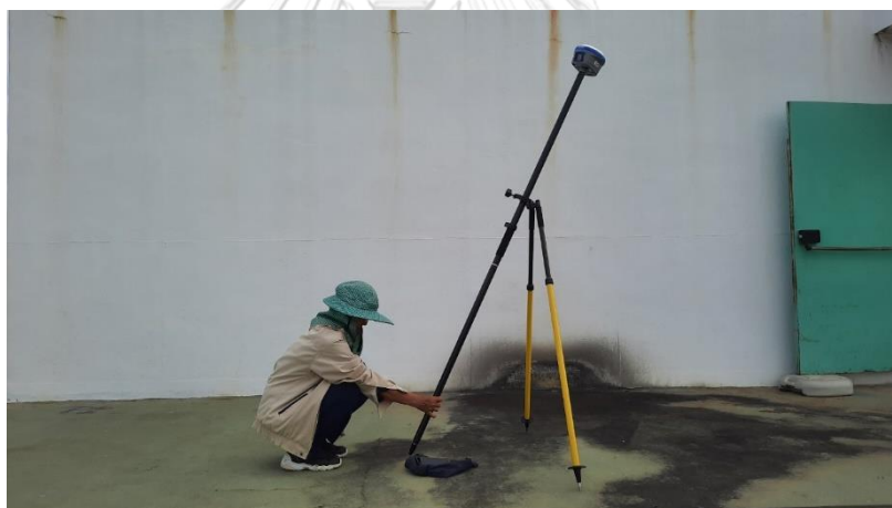
รูปที่ 65 การรังวัดขณะเอียงเสา 25° โดยหันเครื่องรับสัญญาณขนานกับผนัง กรณีทดสอบห่างจากผนัง 2 เมตร
