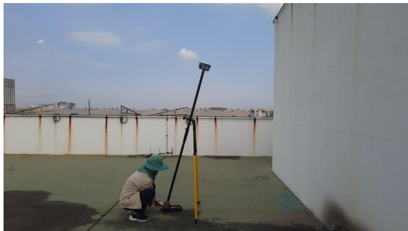
รูปที่ 57 การรังวัดขณะเอียงเสา 15^\circ โดยหันเครื่องรับสัญญาณเข้าหาผนัง กรณีทดสอบห่างจากผนัง 2 เมตร
