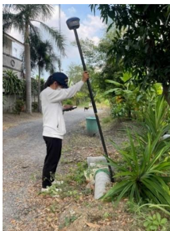
รูปที่ 35 ตัวอย่างการรังวัดขณะเอียงโดยตรงบนหมุดหลักเขตที่ดิน
