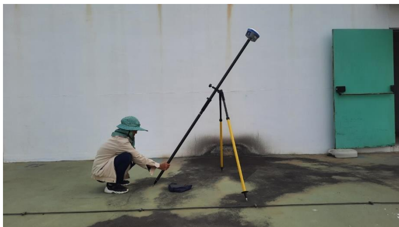
รูปที่ 66 การรังวัดขณะเอียงเสา 35° โดยหันเครื่องรับสัญญาณขนานกับผนัง กรณีทดสอบห่างจากผนัง 2 เมตร
