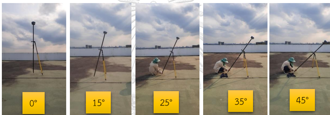
รูปที่ 32 การรังวัดขณะเอียงเสาบบริเวณดาดฟ้า กรณีรังวัดในพื้นที่โล่ง ด้วยมุม 0^\circ , 15^\circ , 25^\circ , 35^\circ และ 45^\circ (จากรูปซ้ายไปขวา ตามลำดับ)
