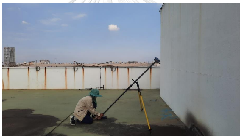
รูปที่ 60 การรังวัดขณะเอียงเสา 45° โดยหันเครื่องรับสัญญาณเข้าหาผนัง กรณีทดสอบห่างจากผนัง 2 เมตร
