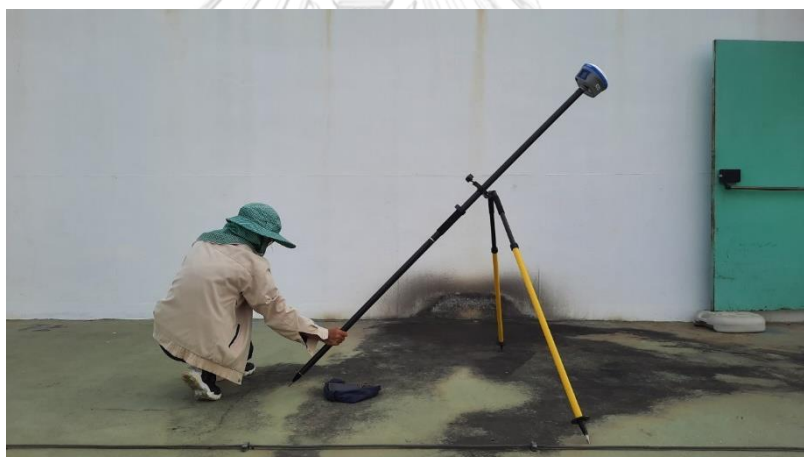
รูปที่ 67 การรังวัดขณะเอียงเสา 45° โดยหันเครื่องรับสัญญาณขนานกับผนัง กรณีทดสอบห่างจากผนัง 2 เมตร
