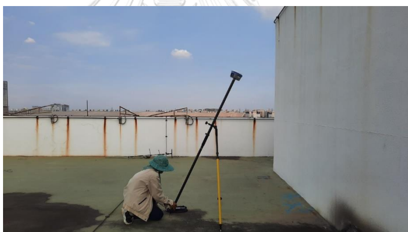
รูปที่ 58 การรังวัดขณะเอียงเสา 25^\circ โดยหันเครื่องรับสัญญาณเข้าหาผนัง กรณีทดสอบห่างจากผนัง 2 เมตร
