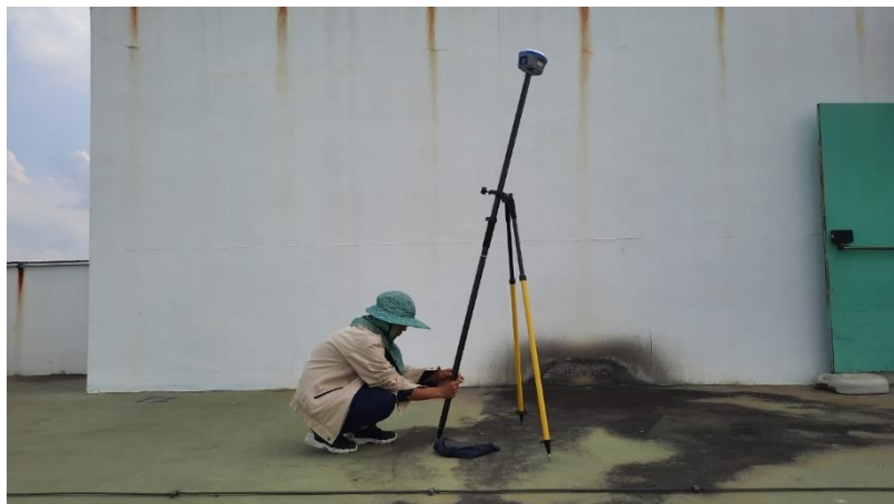
รูปที่ 64 การรังวัดขณะเอียงเสา 15° โดยหันเครื่องรับสัญญาณขนานกับผนัง กรณีทดสอบห่างจากผนัง 2 เมตร
