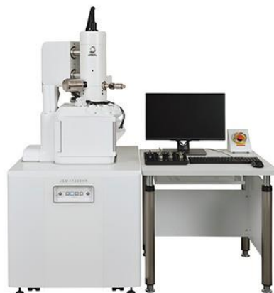
รูปที่ 3.3 กล้องจุลทรรศน์อิเล็กตรอนแบบส่องกราด รุ่น JEOL JSM-IT500HR [57]
