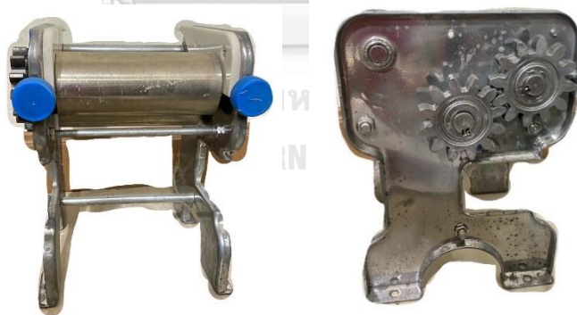
รูปที่ 14 เครื่องรีดแผ่นแบบคที่เรียเซลลูโลส
