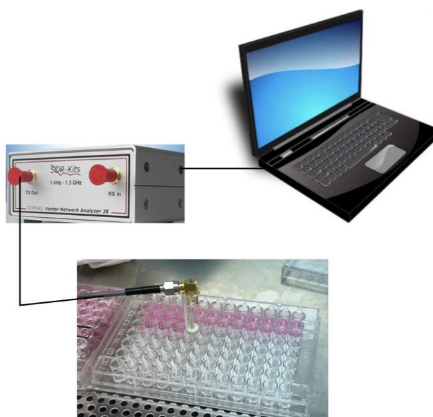
ภาพที่ 9 เครื่องวัดค่าความต้านทานที่ติดเข้ากับถาดเลี้ยงเซลล์
