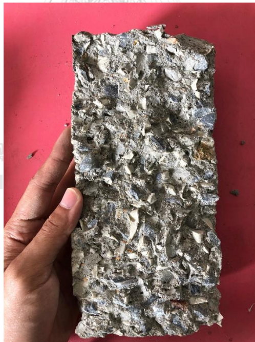
รูปที่ 44 ตัวอย่างส่วนผสมที่เป็นพอร์ตแลนด์ซีเมนต์คอนกรีตที่ถูกผ่าแยกเพื่อดูการกระจายตัวของ พลาสติก
