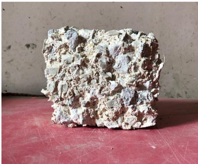
รูปที่ 53 ตัวอย่าง C-PP50 หลังแช่กรดซัลฟิวริกได้ 84 วัน
