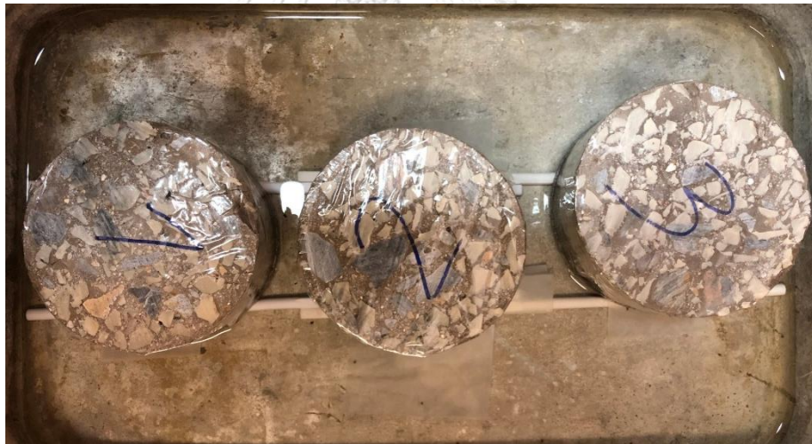
รูปที่ 56 การเตรียมตัวอย่างเพื่อทำการทดสอบอัตราการดูดซึมน้ำของคอนกรีต
