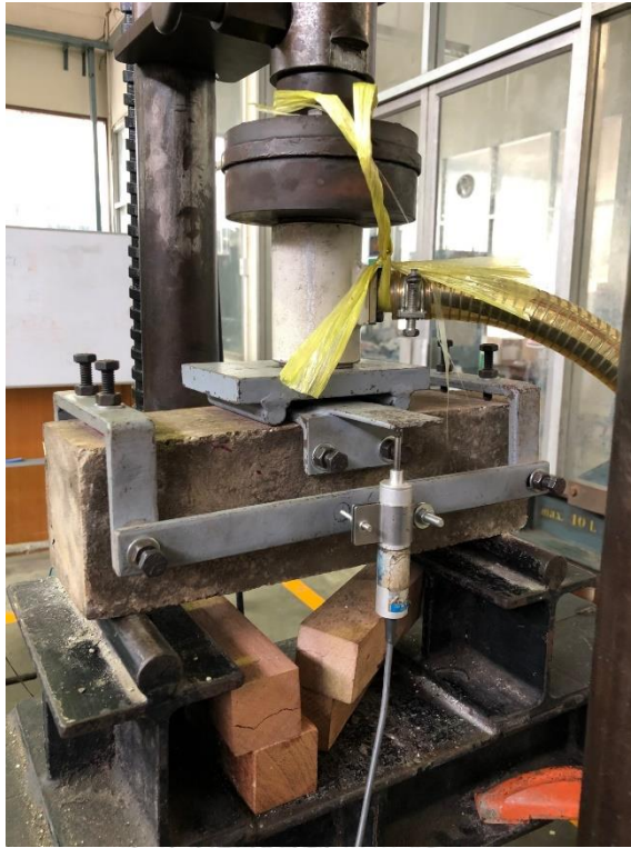
รูปที่ 47 การเตรียมตัวอย่างเพื่อทำการทดสอบกำลังรับแรงดัด
