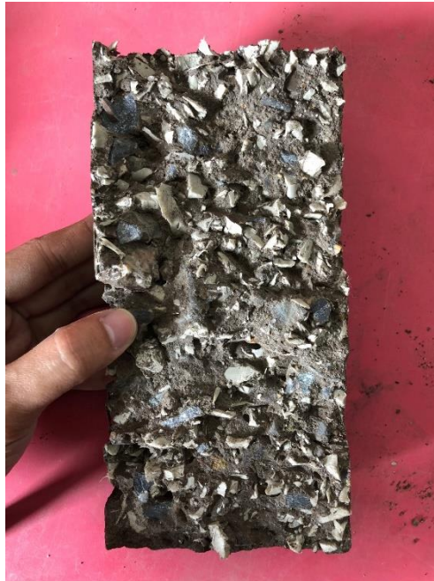
รูปที่ 45 ตัวอย่างส่วนผสมที่เป็นจีโอโพลีเมอร์คอนกรีตที่ถูกทำการผ่าแยกเพื่อดูการกระจายตัวของพลาสติก
