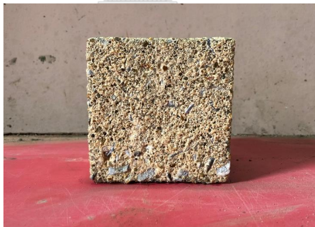
รูปที่ 48 ตัวอย่าง C-PP0 หลังแช่กรดซัลฟิวริกได้ 7 วัน
