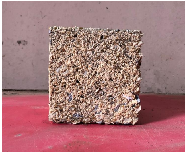
รูปที่ 49 ตัวอย่าง C-PP50 หลังแช่กรดซัลฟิวริกได้ 7 วัน
