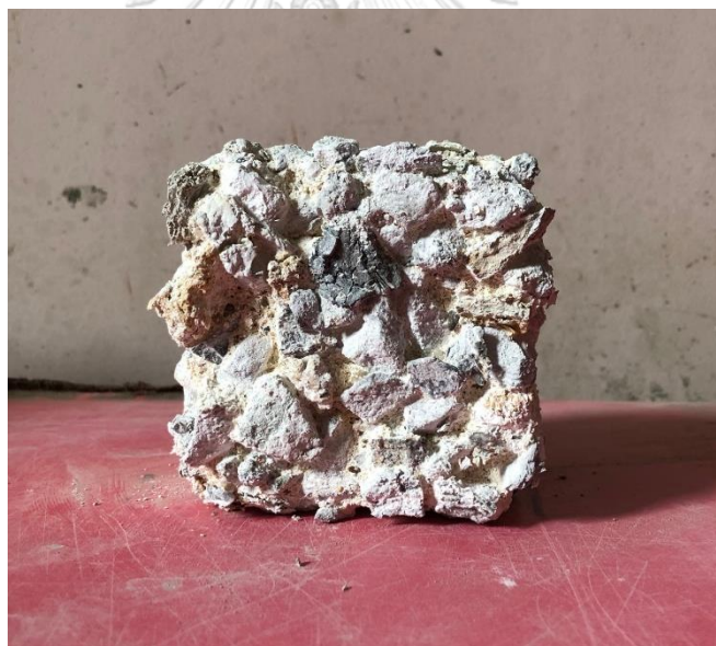
รูปที่ 52 ตัวอย่าง C-PP0 หลังแช่กรดซัลฟิวริกได้ 84 วัน
