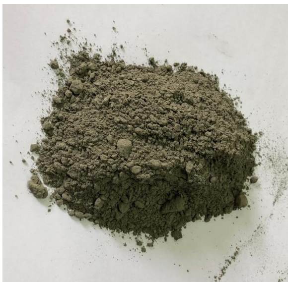
รูปที่ 41 ปูนซีเมนต์พอร์ตแลนด์ประเภทที่ 1
