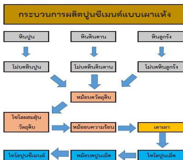
รูปที่ 1 ขั้นตอนการผลิตปูนซีเมนต์ปอร์ตแลนด์ด้วยวิธีเผาแห้ง
