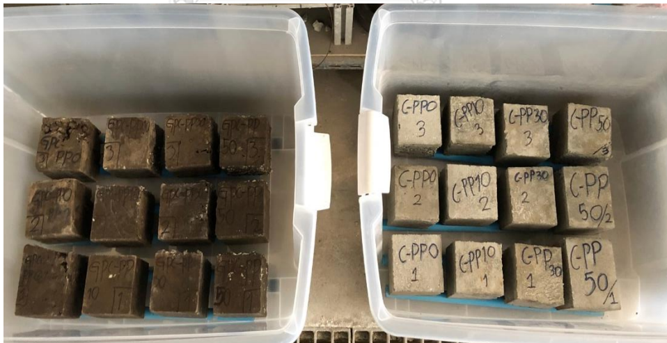
รูปที่ 46 เตรียมตัวอย่างเพื่อทำการทดสอบแช่กรดซัลฟิวริก
