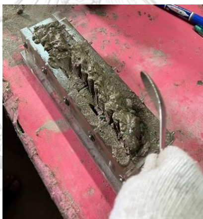
รูปที่ 28 ดันมอร์ตาร์ที่ล้นออกมาเข้าไปอยู่ในแบบจากนั้นทำการกระทุ้งในรอบต่อไป
