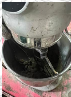
รูปที่ 22 ทำการปาดมอร์ตาร์ที่ติดข้างหม้อผสมลงในหม้อ
