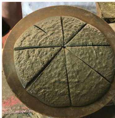
รูปที่ 26 วัดเส้นผ่านศูนย์กลางของมอร์ตาร์ จำนวน 4 ครั้ง ซึ่งมีมุมห่างกัน 45 องศา
