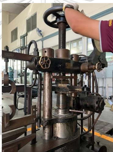
รูปที่ 31 ทดสอบการรับน้ำหนักของมอร์ตาร์ด้วยเครื่องทดสอบ
