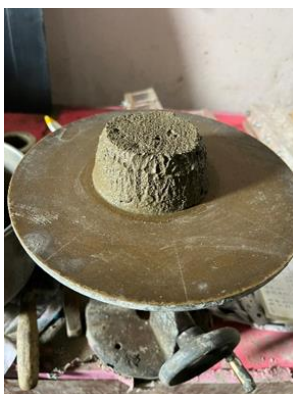
รูปที่ 24 ยกแบบขึ้นในแนวตั้งอย่างช้าๆ จะได้มอร์ตาร์ตามรูปทรงของแบบ
