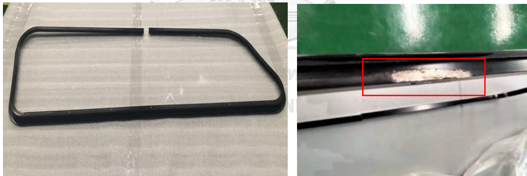
รูปที่ 3.3 ลักษณะข้อบกพร่องประเภทสีแตกของชุดแต่งกรอบกระจกของหลังคารถยนต์เอนกประสงค์
