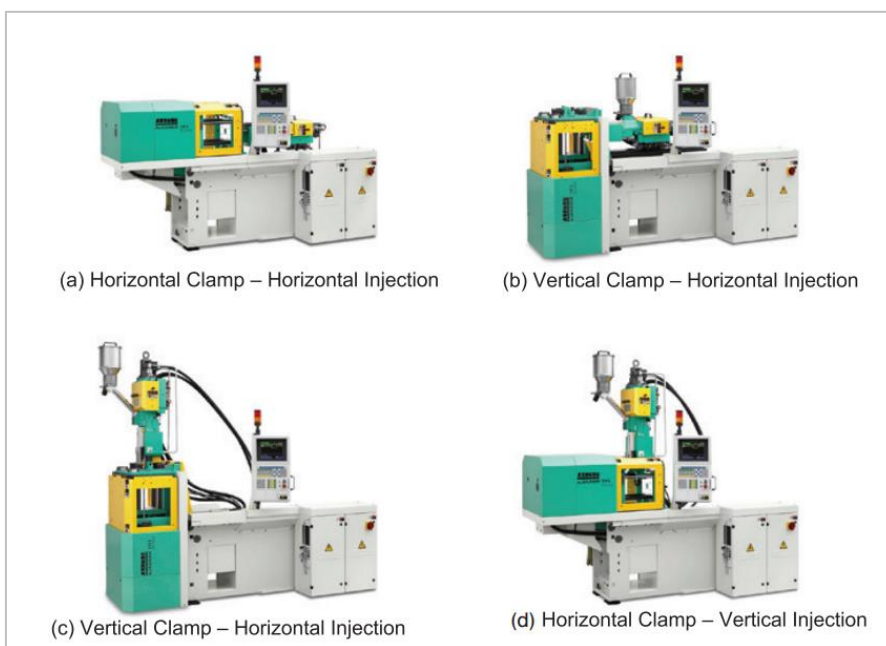
รูปที่ 2.3 การจำแนกประเภทเครื่องฉีดพลาสติกตามตำแหน่งแคลมป์และหัวฉีด
