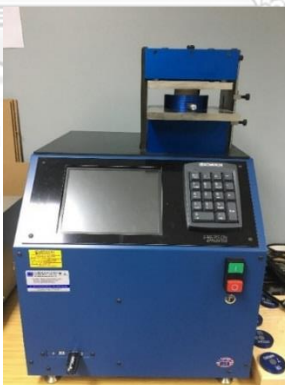
ภาพที่ 2-20 เครื่องวัดความต้านแรงกดในแนววงแหวน
