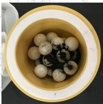
ภาพที่ 3-10 ถ้วยสำหรับใช้ในการบดด้วยลูกบอล
