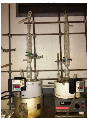
ภาพที่ 3-9 การรีดิวซ์สารแกรฟีนออกไซด์ด้วยกรดแอสคอร์บิก (L-ascorbic acid)
