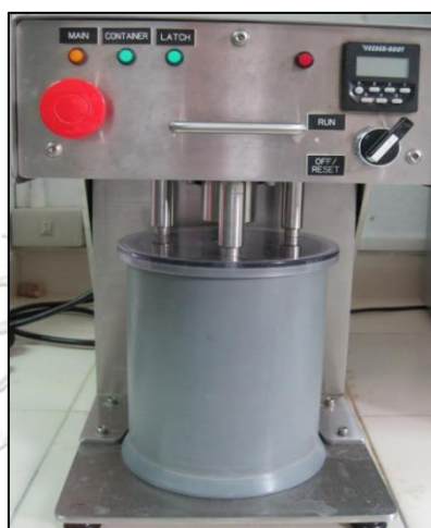
ภาพที่ 3-3 เครื่องตีกระจายเยื่อแบบ disintegrator
