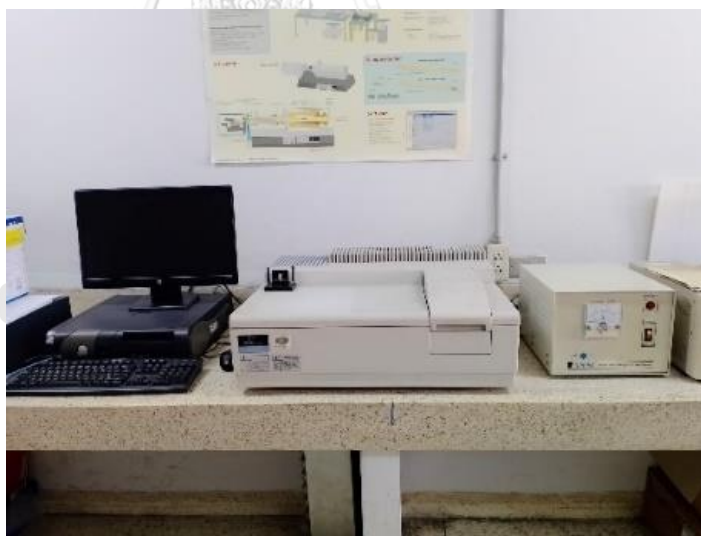
รูปที่ 3.14 เครื่อง UV/Vis Spectrophotometers ยี่ห้อ Perkin Elmer รุ่น LAMBDA
