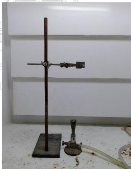
รูปที่ 3.17 อุปกรณ์ทดสอบความสามารถในการติดไฟในแนวตั้ง (Vertical Flammability Test Metho
