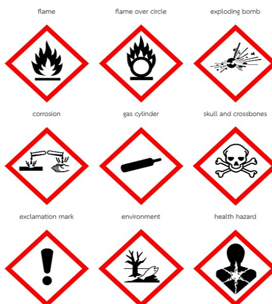
รูปที่ 2.1 สัญลักษณ์แสดงความเป็นอันตรายตามระบบ GHS
