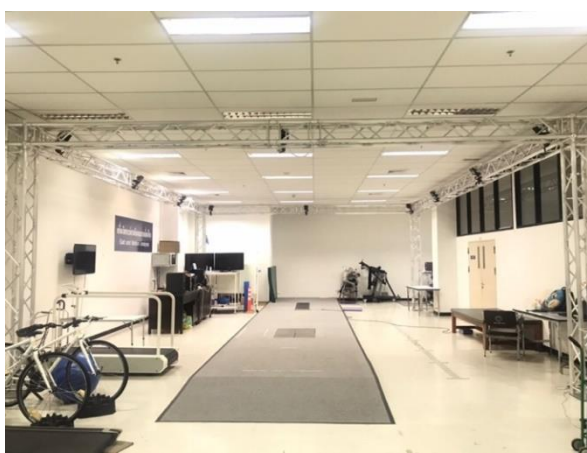
ภาพที่ 12 แสดงเครื่องวิเคราะห์การเคลื่อนไหว และตำแหน่งชุดกล้องอินฟราเรดความเร็วสูง
