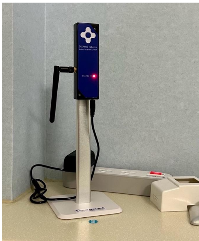
รูปภาพที่ 8 ตัวรับสัญญาณ (Anchor) ติดตั้งในหอผู้ป่วย
