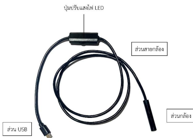
ภาพ 0.3 ส่วนประกอบของ USB Endoscope Camera
