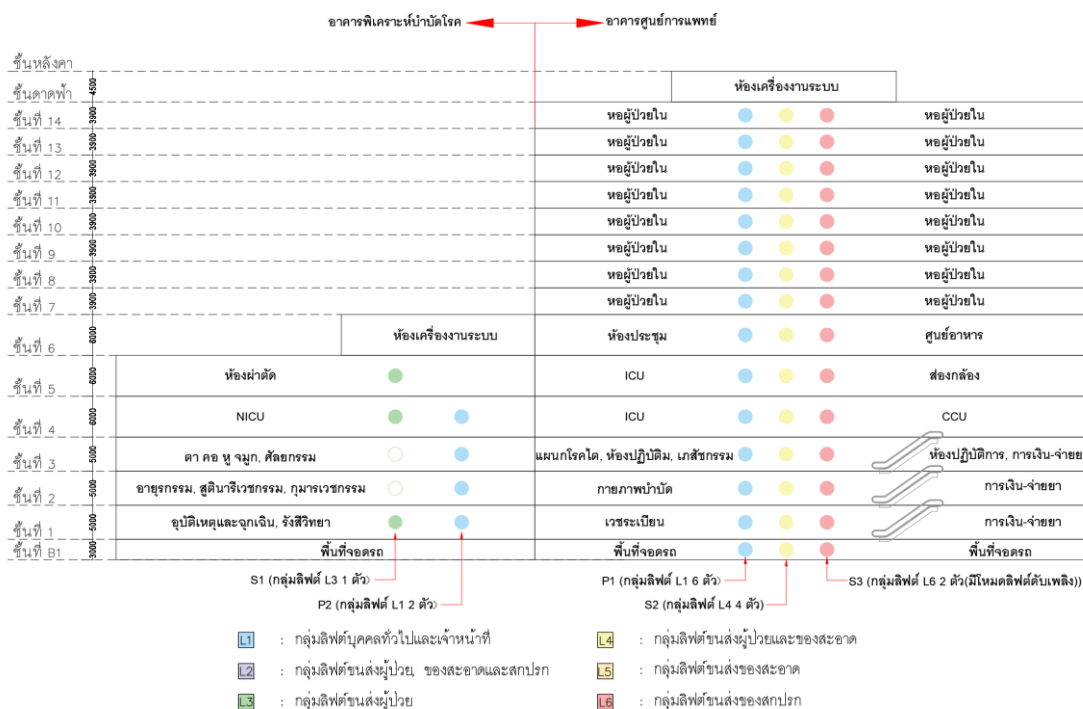
รูปภาพที่ 26 แสดงไดอะแกรมข้อมูลอาคารและข้อมูลลิฟต์ของอาคารกรณีศึกษา G
