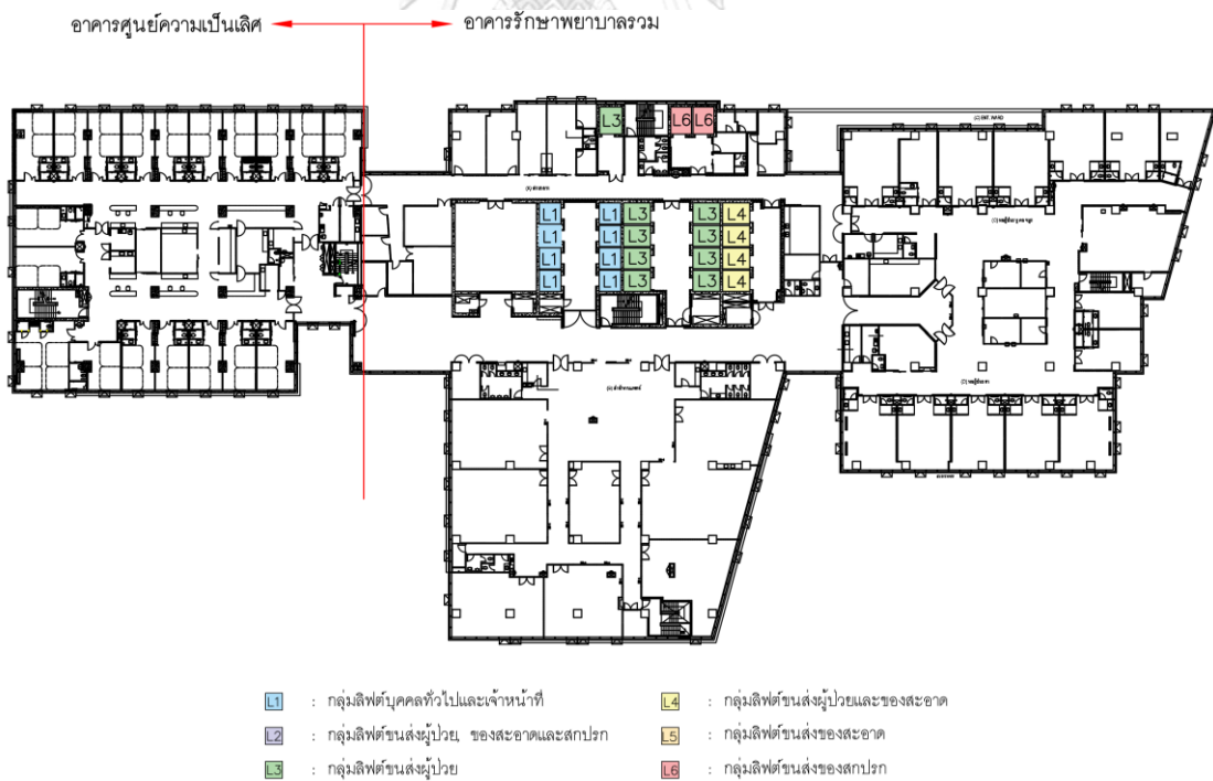
รูปภาพที่ 5 แสดงแบบแปลนและข้อมูลกลุ่มลิฟต์ของอาคารกรณีศึกษา A ชั้น 15
