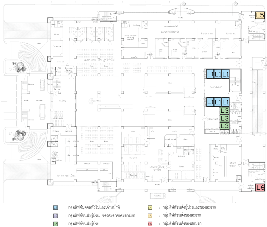
รูปภาพที่ 18 แสดงแบบแปลนและข้อมูลกลุ่มลิฟต์ของอาคารกรณีศึกษา E ชั้น 1
