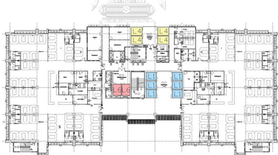
รูปภาพที่ 24 แสดงแบบแปลนและข้อมูลกลุ่มลิฟต์ของอาคารกรณิศึกษา G ชั้น 1
