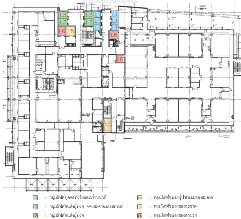
รูปภาพที่ 8 แสดงแบบแปลนและข้อมูลกลุ่มลิฟต์ของอาคารกรณีศึกษา B ชั้น 9
