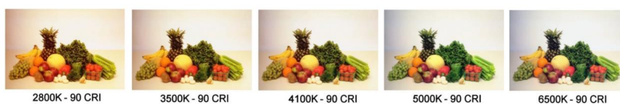
ภาพที่ 2.4 ภาพเปรียบเทียบสีของวัตถุเมื่ออุณหภูมิสีของแสงต่างกันและมีค่า CRI เท่ากัน
