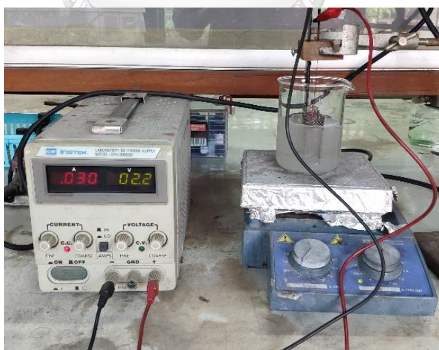
รูปที่ 17 การติดตั้งอุปกรณ์ในการสังเคราะห์พอลิพีร์โรลบนแผ่นทองแดง
