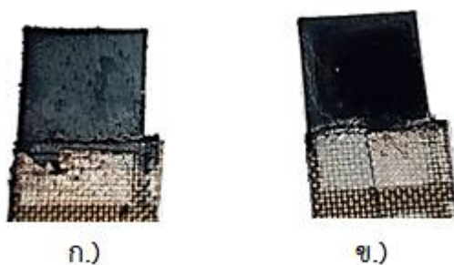
รูปที่ 31 ลักษณะฟิล์มพอลิไพร์โรลที่ถูกเคลือบบนแผ่นทองแดงที่มีคาร์บอนวัลแคน และไม่มีคาร์บอนวัลแคน ก.) มีคาร์บอนวัลแคนในฟิล์มพอลิไพร์โรล ข.) ไม่มีคาร์บอนวัลแคน
