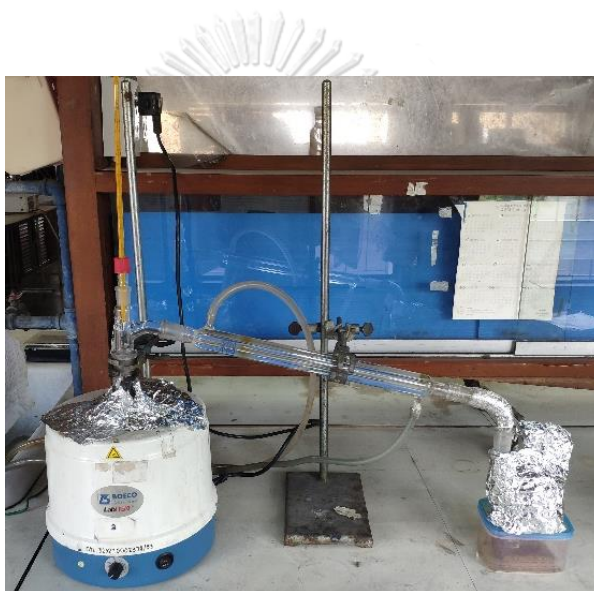
รูปที่ 14 การติดตั้งอุปกรณ์การกลั่นพีริโรลมอนอเมอร์
