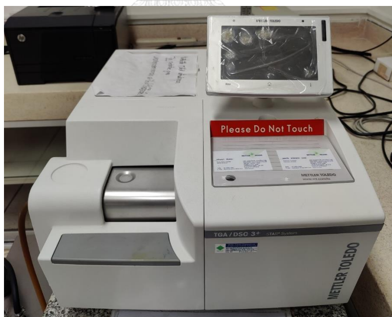
รูปที่ 3.7 เครื่องวิเคราะห์น้ำหนักภายใต้ความร้อน (Thermogravimetric analyzer, TGA)
