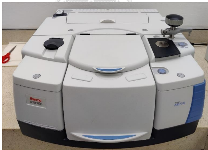
รูปที่ 3.4 เครื่องฟูเรียร์แทรนสฟอร์มอินฟราเรดสเปกโตรมิเตอร์
