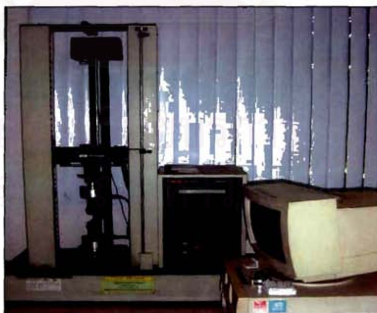
รูปที่ 3.8 เครื่อง Instron Testing Machine Model 1101
