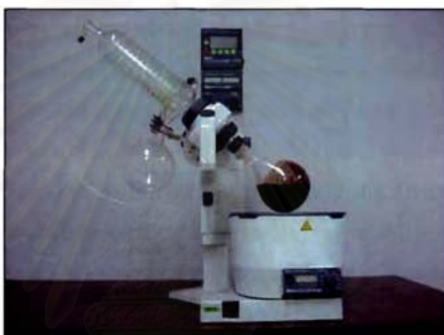
รูปที่ 3.2 เครื่อง BUCHI Rotavapour R-205
