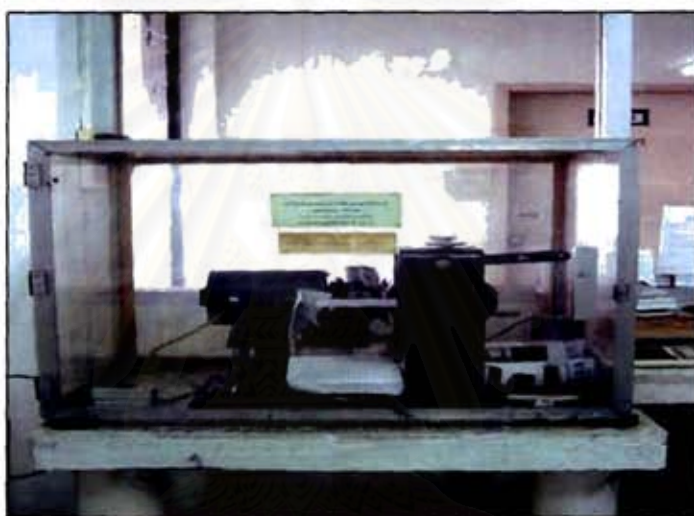
รูปที่ 3.11 เครื่องทดสอบความต้านทานการสึกหรอ (Akron Abrasion Tester) Model APH-40
