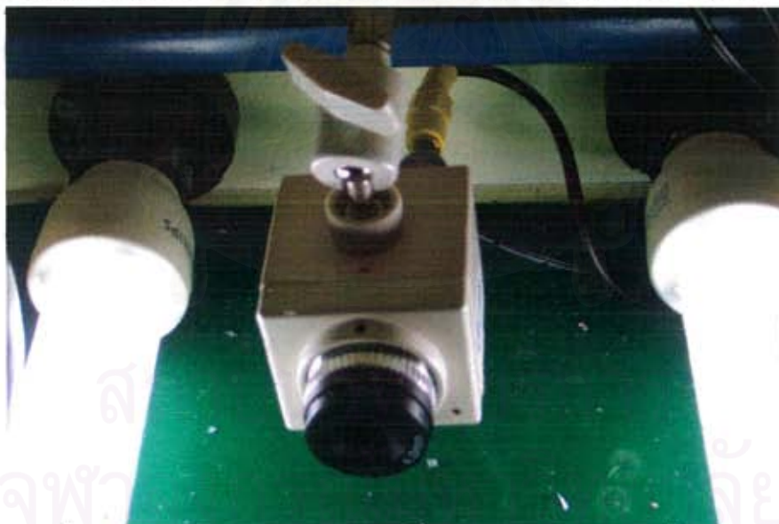
ภาพที่ 3 แสดงให้เห็นกล้องวงจรปิดที่ยึดกับแกนเหล็ก รวมทั้งตำแหน่งของไฟ
