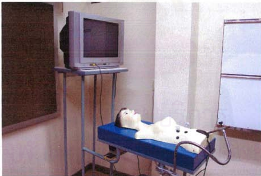
ภาพที่ 1 ชุดฝึกผ่าตัดผ่านวิดีโอทัศน์หลังจากได้มีการประดิษฐ์จนสำเร็จเรียบร้อยแล้ว ประกอบไปด้วยหุ่นซึ่งมีชุดถ่ายทอดภาพออกไปยังโทรทัศน์
