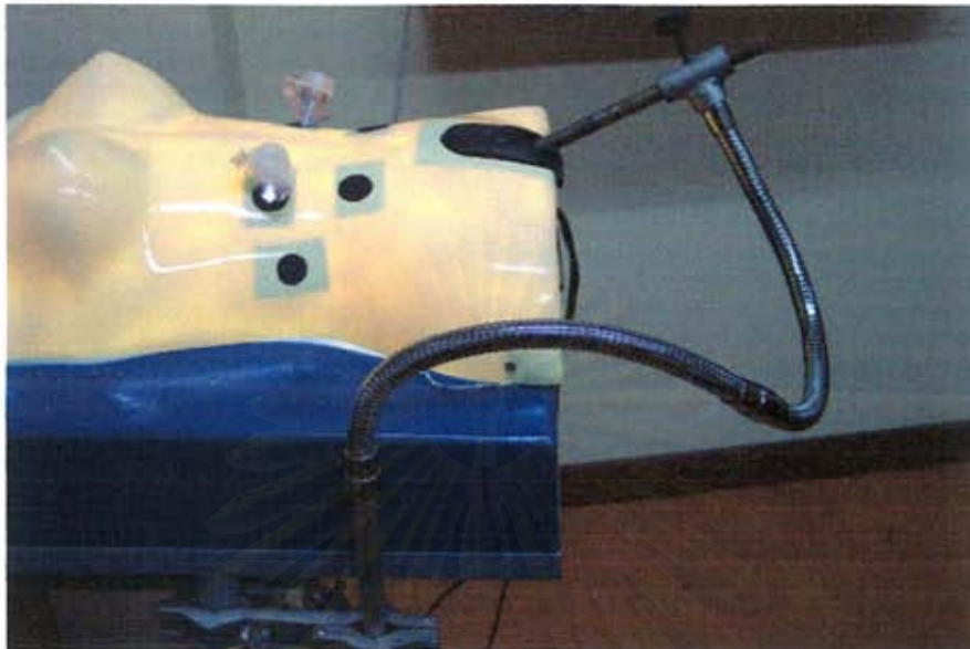
ภาพที่ 2 แสดงถึงตำแหน่งของช่องซึ่งใช้สำหรับใส่เครื่องมือผ่านช่องท้อง และแกนด้านหลังซึ่งยึดกับกล้องวงจรปิดที่อยู่ภายใน โดยแกนนี้จับกับขาไมโครโฟน
