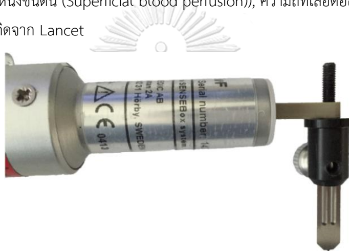
รูปที่ 2.19 การจัดอุปกรณ์ SPT metal Lancet ติดกับ The SENSEBox Electronic von Frey weight transducer (43)
