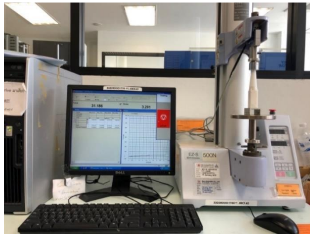
รูปที่ 3.1 การทดสอบแรงกดด้วยเครื่อง Universal Testing Machine, SHIMADZU (รุ่น EZ-S, ยี่ห้อ SHIMADZU, JAPAN.)
