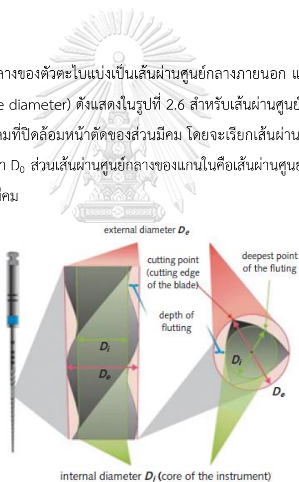
รูปที่ 2.6 เส้นผ่านศูนย์กลางภายนอก ( D_e ) และเส้นผ่านศูนย์กลางภายใน ( D_i ) ของตะไบ
