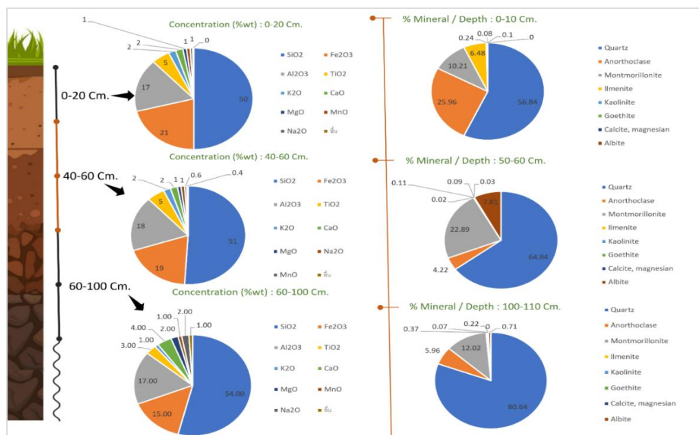
รูปที่ 64 สรุปผลการวิเคราะห์ XRF และ XRD
