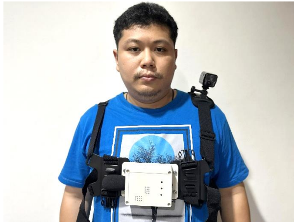
รูปที่ 4.1 รูปภาพแสดงเครื่องมือวัดมลพิษทางอากาศและเสียงที่ติดไว้กับแรงงาน
