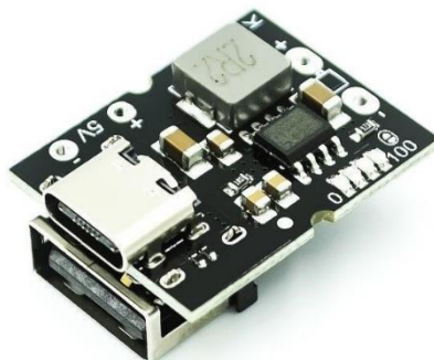
รูปที่ 4.9 รูปภาพแสดงโมดูลชาร์จแบตเตอรี่ลิเธียม 4.2V พร้อมวงจรจ่ายไฟและวงจรป้องกัน 5V2A charge integrated module Type-C input ที่มา : (Cybertice, 2564)
