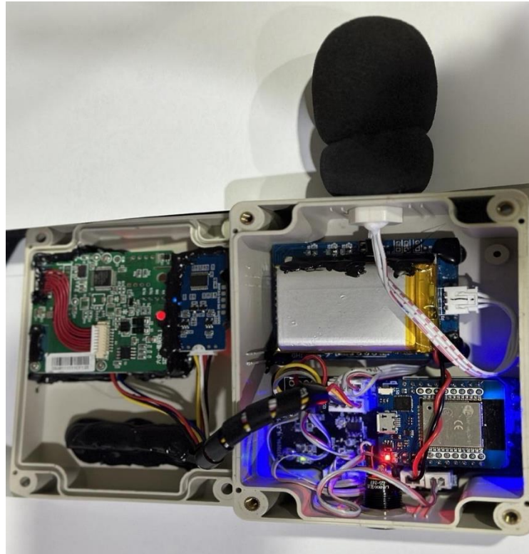
รูปที่ 4.3 รูปภาพแสดงอุปกรณ์ในกล่องเครื่องมือวัดมลพิษทางอากาศและเสียง ประกอบไปด้วย บอร์ด MCU ESP-32 เซนเซอร์วัดปริมาณฝุ่นละออง เซนเซอร์วัดปริมาณก๊าซ เซนเซอร์วัดความดังของเสียง แผ่นวงจรพิมพ์ แบตเตอรี่สำรองพลังงาน และหลอดไฟ LED
