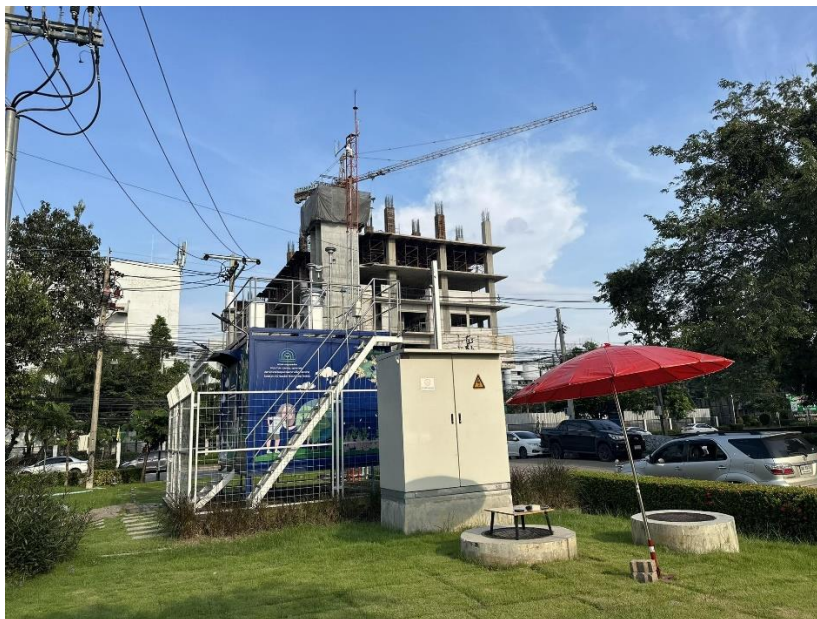
รูปที่ 4.33 รูปภาพแสดงการสอบเทียบเครื่องมือวัดมลพิษทางอากาศ กับสถานีวัดมลพิษทางอากาศสถานี 13T กรมควบคุมโรค
