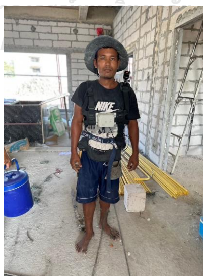
รูปที่ 5.39 รูปภาพแสดงแรงงานที่ติดตั้งเครื่องมือวัดปริมาณมลพิษทางอากาศและเสียงส่วนบุคคล (กิจกรรมงานประกอบแบบหล่อคอนกรีต คนที่ 1)
