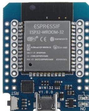
รูปที่ 4.4 รูปภาพแสดงโมดูล ESP32 MH-ET LIVE D1 mini ESP32 ESP-32 WiFi+Bluetooth Internet of Things development board CH9102 ที่ใช้ในงานวิจัย
