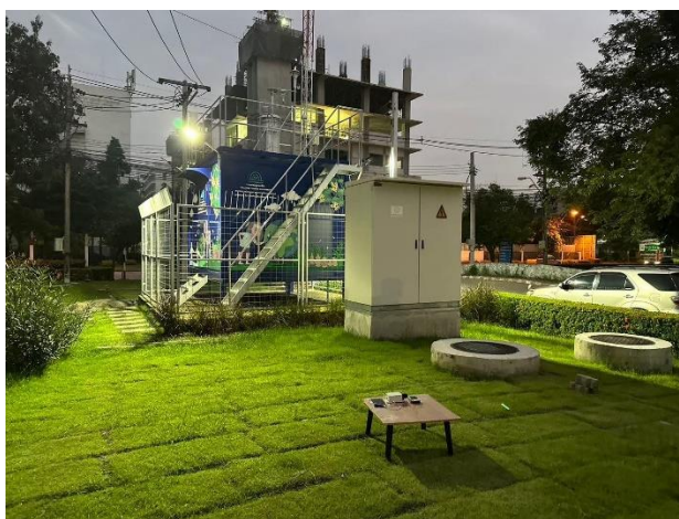
รูปที่ 4.34 รูปภาพแสดงการสอบเทียบเครื่องมือวัดมลพิษทางอากาศ กับสถานีวัดมลพิษทางอากาศสถานี 13T กรมควบคุมโรค
