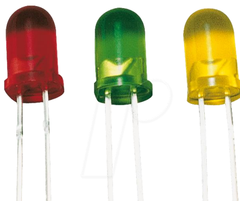
รูปที่ 4.11 รูปภาพแสดงไดโอดเปล่งแสง (Light-emitting diode,LED)
