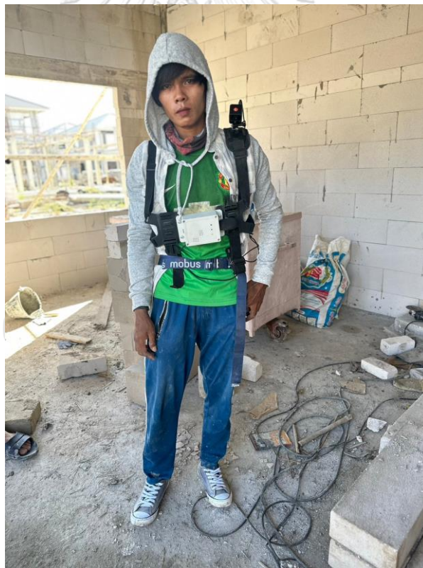
รูปที่ 5.19 รูปภาพแสดงแรงงานที่ติดตั้งเครื่องมือวัดปริมาณมลพิษทางอากาศและเสียงส่วนบุคคล (กิจกรรมก่ออิฐมวลเบา คนที่ 1)
