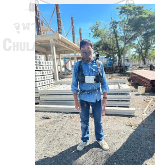
รูปที่ 5.32 รูปภาพแสดงแรงงานที่ติดตั้งเครื่องมือวัดปริมาณมลพิษทางอากาศและเสียงส่วนบุคคล (กิจกรรมทาสี คนที่ 1)
