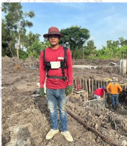
รูปที่ 5.2 รูปภาพแสดงแรงงานที่ติดตั้งเครื่องมือวัดปริมาณมลพิษทางอากาศและเสียงส่วนบุคคล (กิจกรรมตัดและตัดเหล็ก คนที่ 1)
