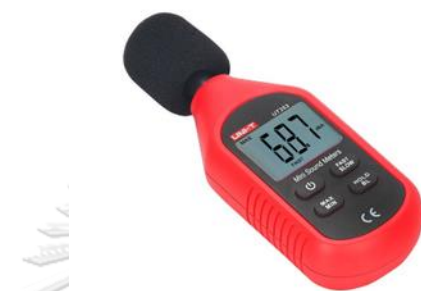
รูปที่ 4.35 รูปภาพแสดงเครื่องมือวัดความดังของเสียงเสียง UNI-T รุ่น UT353 (ที่มา : www.meters.uni-trend.com/product/ut353-ut353bt/ )
