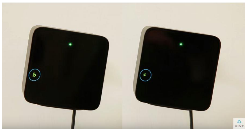
รูปที่ 4.8 ลักษณะ Base Station ที่พร้อมใช้งาน
