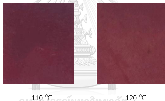
รูปที่ 4.8 การปรากฏสีแดงของแผ่นฟิล์ม poly(PCDA)/ZnO/NR นาโนคอมพอสิต เมื่อคงรูปที่อุณหภูมิ 110 และ 120 องศาเซลเซียส เป็นเวลา 2 ชั่วโมง
