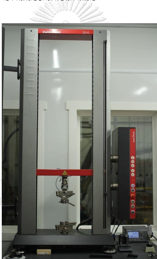
รูปที่ 3.5 เครื่องทดสอบความต้านทานแรงดึง (tensile strength tester) Zwick/Roell รุ่น Z010
