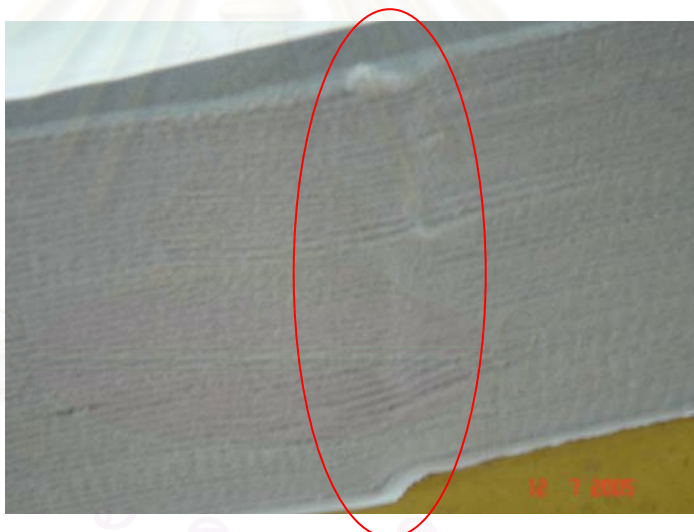
รูปที่ 3- 4 รูปแสดงการตัดแล้วหน้าตัดของชิ้นงานไม่เรียบ
