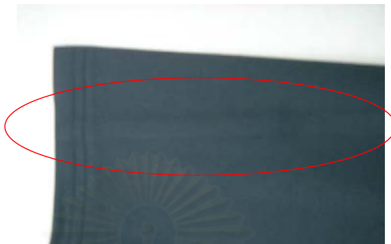
รูปที่ 3-5 แสดงปัญหาตะเข็บขึ้นเงา
