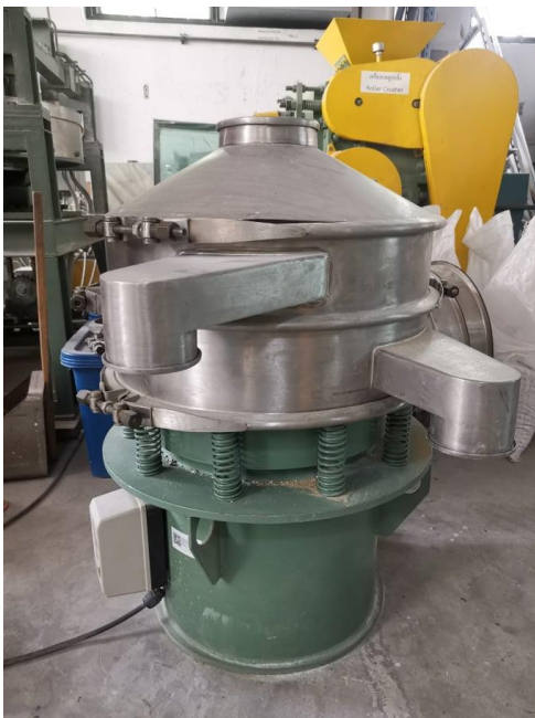
รูปที่ 3.3 เครื่อง Vibrating sieve เบอร์ 304 ขนาด 500 x100 มิลลิเมตร
