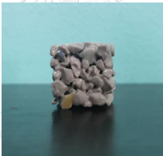
รูปที่ 4.9 บล็อกพรุนที่ใช้เงื่อนไขสัดส่วนปริมาตรวัสดุเชื่อมประสานต่อมวลรวมหยาบ
