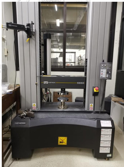
รูปที่ 3.13 เครื่องมือ Universal testing machine ของบริษัท Instron รุ่น 5843
