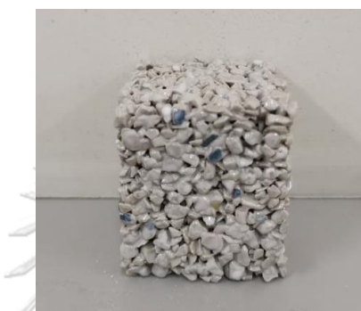
รูปที่ 3.10 บล็อกพรุนจากเศษเซรามิกขนาด 5 \times 5 \times 5 เซนติเมตร
