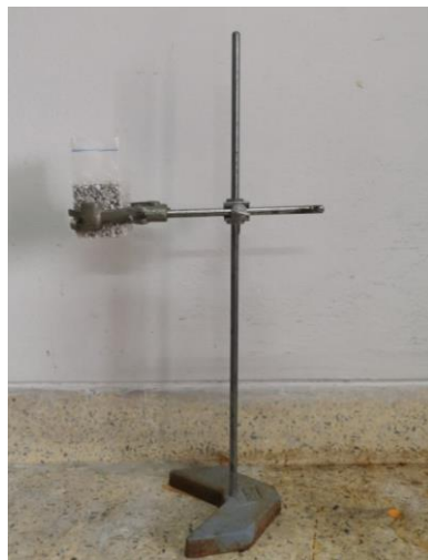
รูปที่ 3.12 อุปกรณ์ทดสอบอัตราการไหลซึมน้ำของบล็อกพูน
