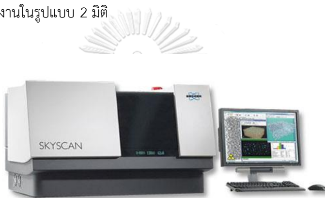
รูปที่ 3.14 เครื่องเอ็กซ์เรย์คอมพิวเตอร์ระดับไมโครเมตร (Micro-CT) ของบริษัท Bruker รุ่น SKYSCAN
