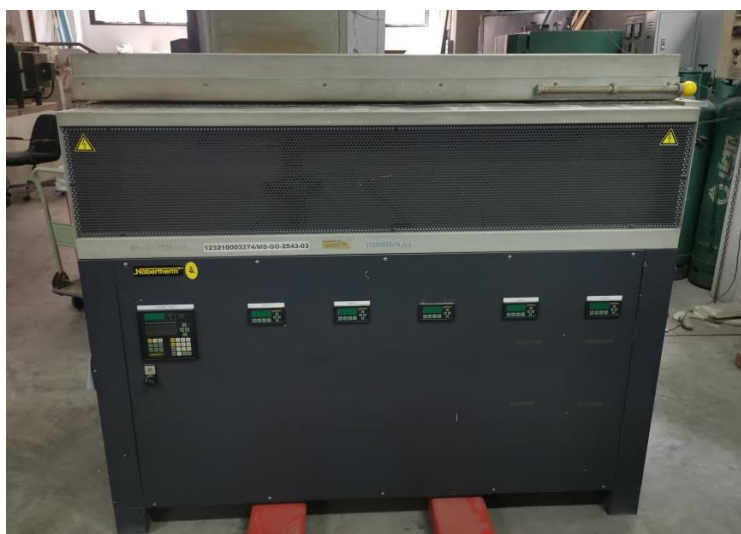
รูปที่ 3.2 เตา Gradient 6 ช่วงอุณหภูมิ ของบริษัท Nabertherm รุ่น GR 1300/13
