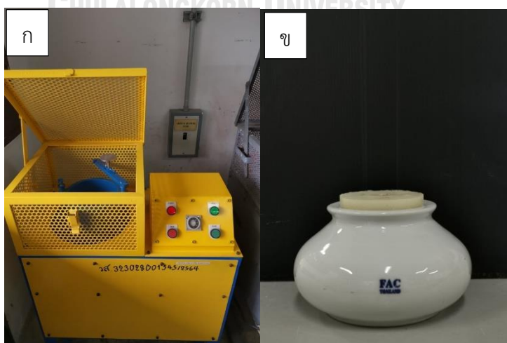
รูปที่ 3.4 ก)เครื่องมือ High speed ball mill ข)หม้อบดพอร์ซเลน
