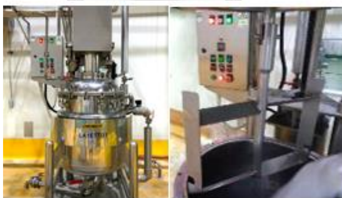
ภาพที่ 3.1 เครื่อง Vacuum jacket pot ที่โรงงานผลิตน้ำซุภายในเครือเบทาโกร
