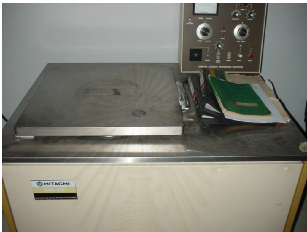
รูปที่ 3.7 เครื่องปั่นยางด้วยความเร็วสูงและอุณหภูมิต่ำ
