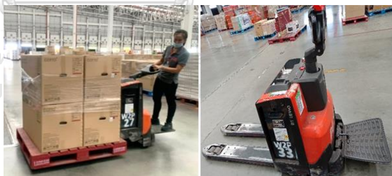
รูปที่ 3-6 Power Pallet Truck ขณะลำเลียงสินค้า
