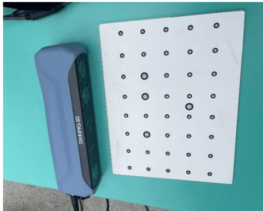
รูปที่ 47 เครื่อง Shining 3D Einstar 3D scanner และ Calibration board
