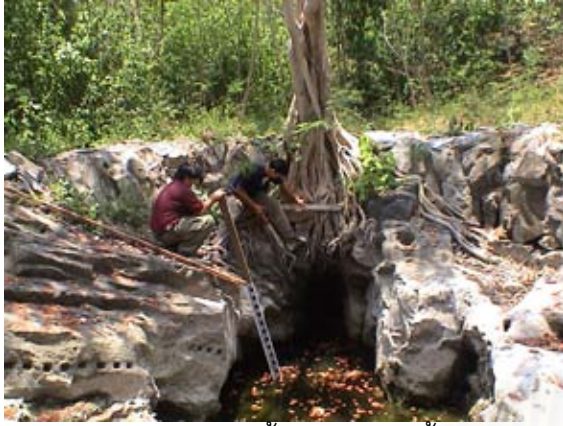
เตรียมติดตั้งไม้วัดระดับน้ำ (1)
