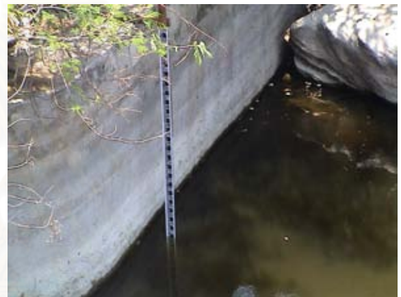
ไม้วัดระดับน้ำเมื่อมองจากเขตก้นด้านบนของบ่อ
