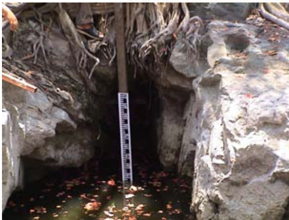
ไม้วัดระดับน้ำเมื่อติดตั้งเสร็จแล้ว
