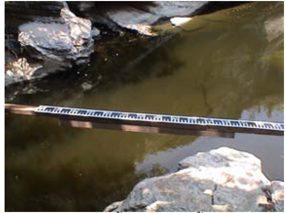
เตรียมติดตั้งไม้วัดระดับน้ำ (2)
